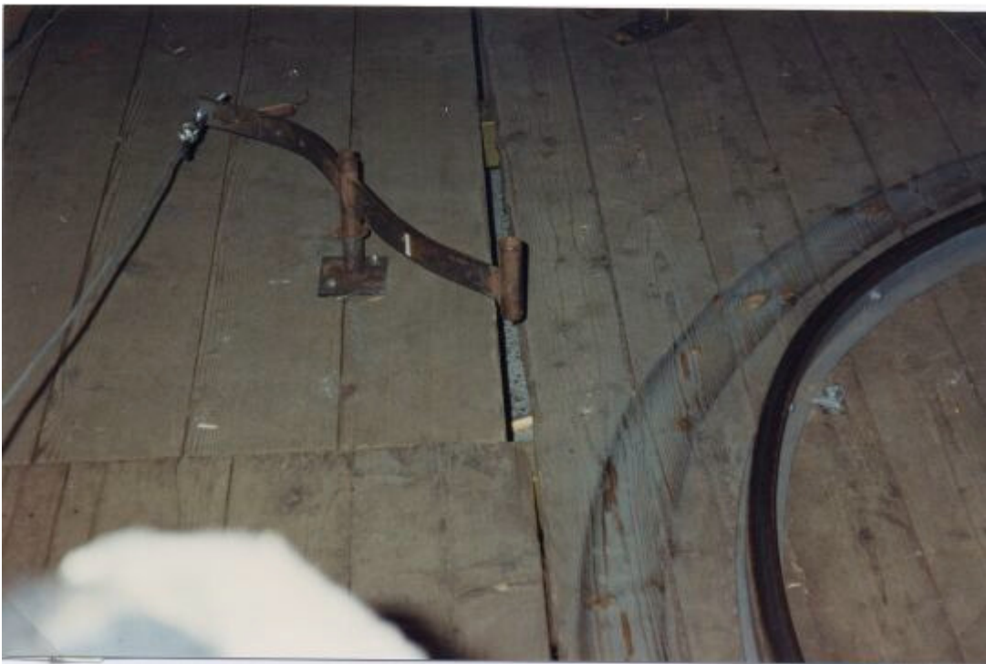
Hebel und Draht als Auslösemechanismen in der Wiener Prater-Geisterbahn. Photo 1992.
